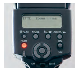
Ein moderner Kamera-Systemblitz mit E-TTL-Funktion steuert das Licht mit sehr genauer Dosierung (Blitzdauer) selbst bei indirektem Blitzen mit ausgeklappter Streuscheibe
